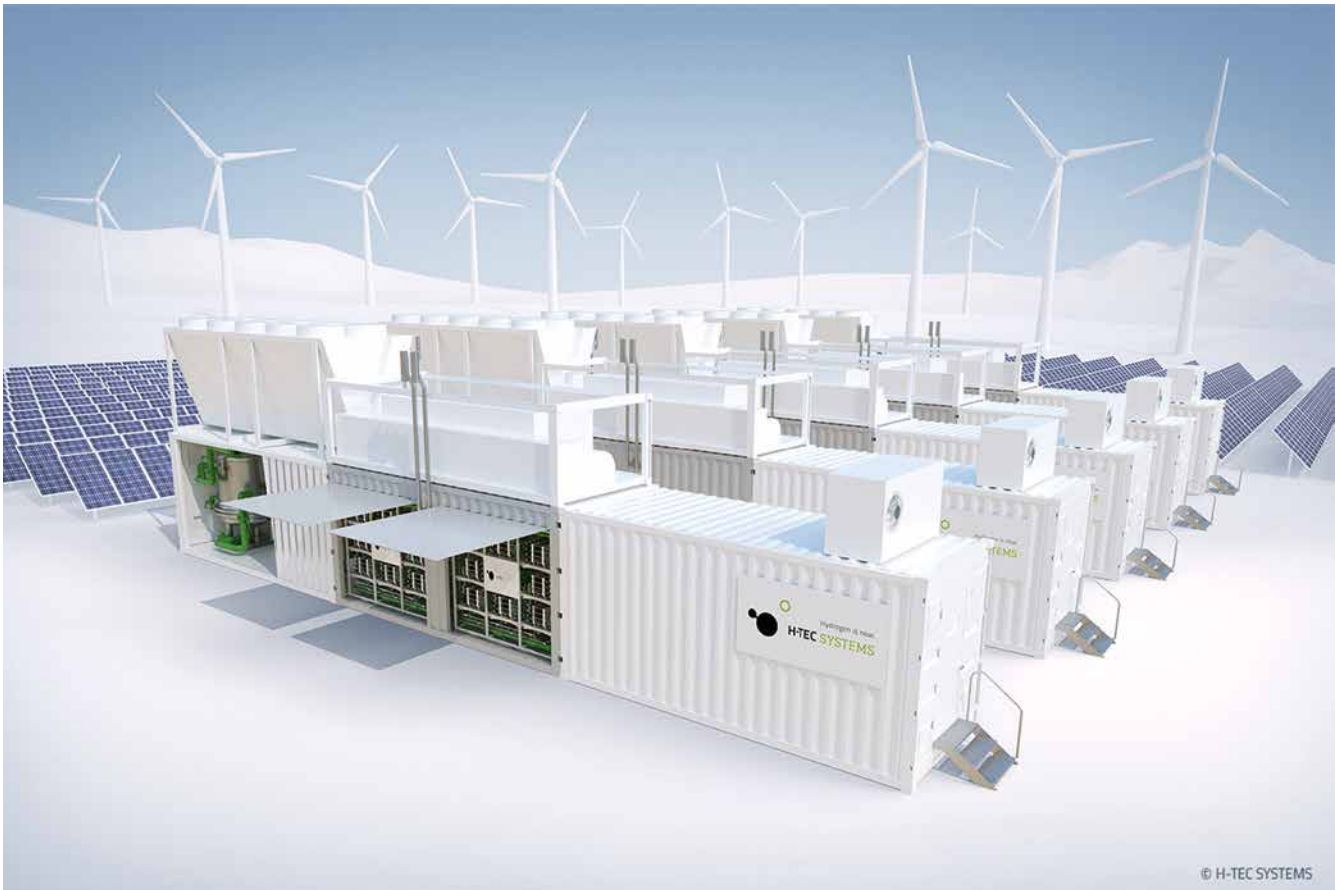
Abb. 3: Mit dem modularen Baukastensystem Hydrogen Cube System (HCS) von MAN Energy Solutions lassen sich PEM-Elektrolyseanlagen im Bereich 10 bis 100 MW realisieren
