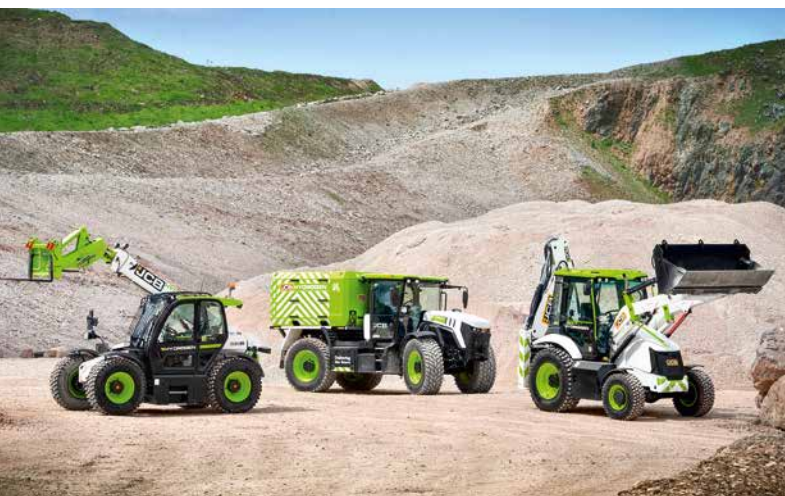
Abb. 1: Die mobile H 2 -Betankungsstation mit dem wasserstoffbetriebenen Teleskoplader und Bagger [Quellen: JCB]
