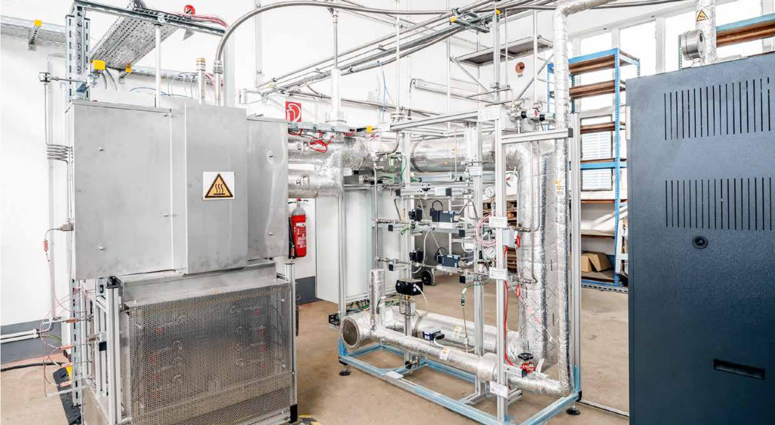
Abb. 2: Energiespeicher Feredox10 im Technikum von Wolf Energetik. Bis zum Sommer soll die größere Variante Feredox1000 folgen, die dieselbe Größe haben wird, die später auch für den Zugantrieb verbaut werden soll [Quelle: Wolf Energetik]
