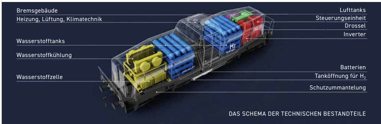
Abb. 2: Schematischer Aufbau der SM42-6Dn [Quelle: PESA]
