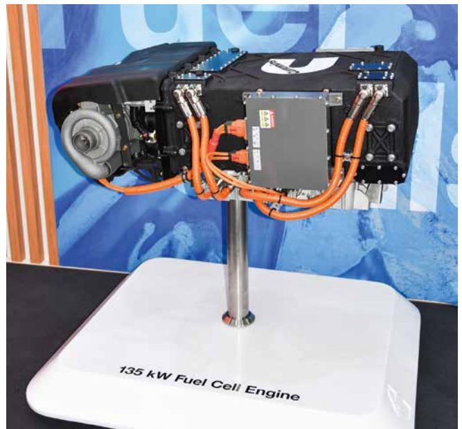
Abb. 9: Cummins' 135-kW-Brennstoffzellensystem für Nfz
