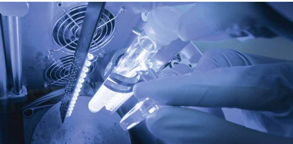
Abb. 1: Photoreaktor: Bestrahlungsapparat im Institut für Anorganische Chemie [Quelle: Heiko Grandel]
