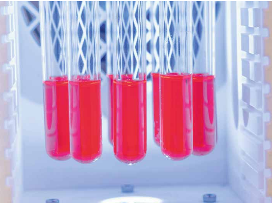
Abb. 2: Katalyselösungen mit Ruthenium-Farbstoff werden im Labor mit Licht bestrahlt [Quelle: Eberhardt/Uni Ulm]
