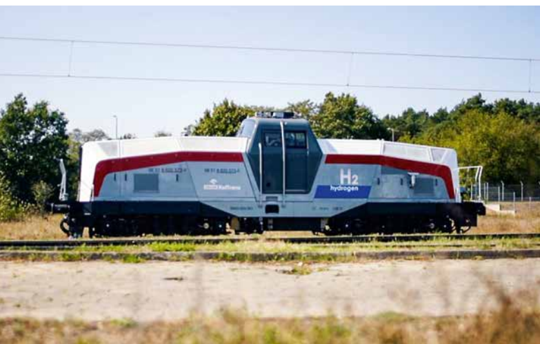
Abb. 1: H 2 -betriebene Rangierlok SM42-6Dn [Quelle: PESA]
