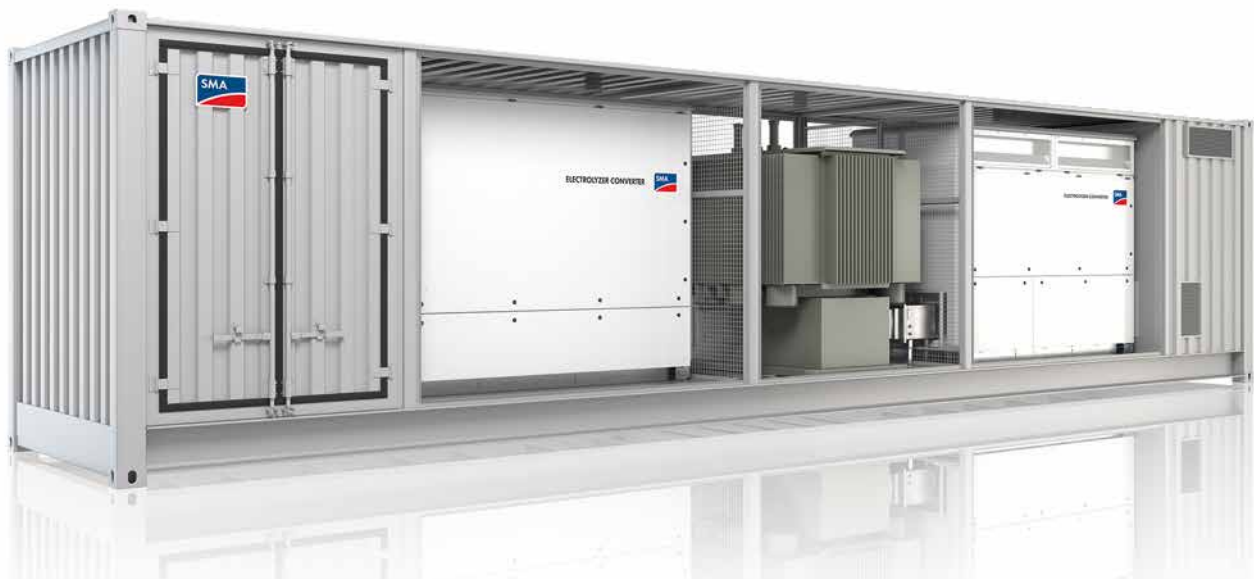
Abb. 1: 40-Fuß-Station: MVPS 40 mit zwei Elektrolyseur-Konvertern (EC-UP) – Leistung bis 8 MVA [Quelle: SMA Sunbelt Energy GmbH]
