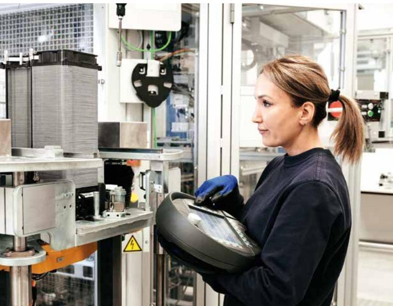
Abb. 2: Im schwäbischen Dettingen/Erms hat EKPO eine hochautomatisierte Stack-Fertigung mit einer Produktionskapazität von 10.000 Einheiten pro Jahr aufgebaut [Quelle: EKPO]
